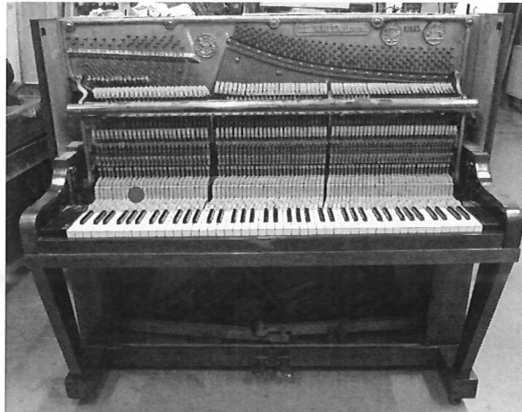
Bild 1: Klavier mit der heute üblichen Unterdämpfermechanik. Der rote Punkt zeigt die übliche Position von Bleigewichten in den Tastenhebeln.
